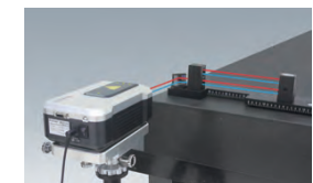
Ebenheitsmessung von Granittischen
