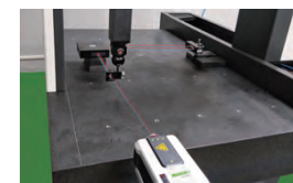
Rechtwinkligkeitsmessung von KMG's
